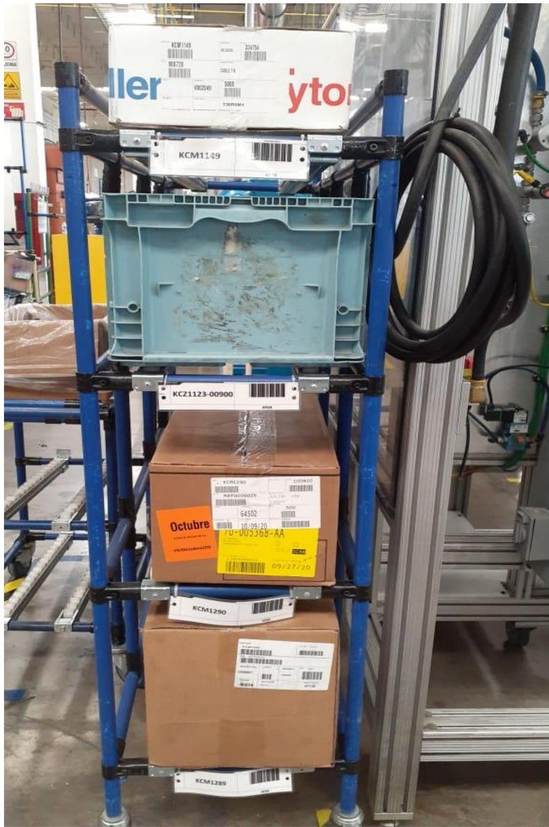
En esta imagen se observa un WIP que esta ubicado en una de las líneas de producción. Se puede observar las etiquetas de identificación por numero de parte y el código de barras para que el materialista al momento de entregar el material, con ayuda del escáner, transfiera el material.
